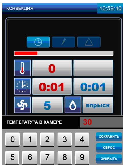
Рис.13.Редактирование параметра « ТЕМПЕРАТУРА В КАМЕРЕ »
