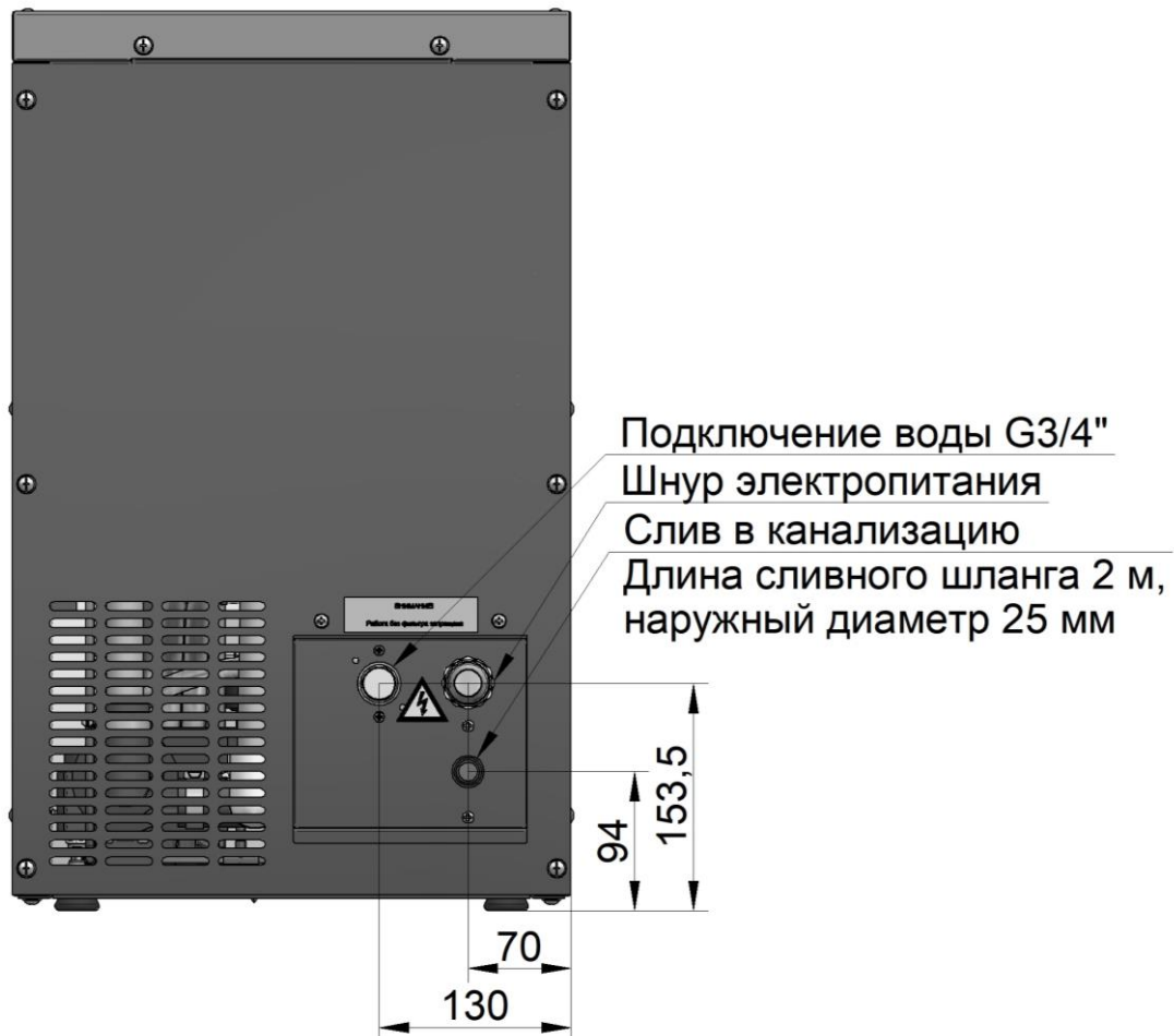
Рис. 5 Схема подключения льдогенератора
